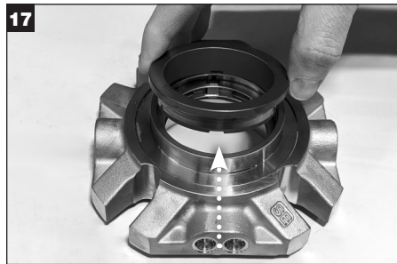
Den inneren Dichtungsring (Gleitring) aus dem Dichtungsflansch ausbauen und entsorgen.
