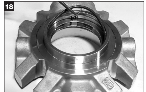
Die inneren Gleitring-O-Ring (X) aus dem Adapter entfernen und entsorgen.
