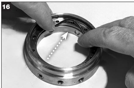
Eine dünne Fettschicht auf den Klemmring Hülsen-O-Ring (Y) auftragen und diesen in die Nut für den Klemmring am kleineren Innendurchmesser einsetzen.
