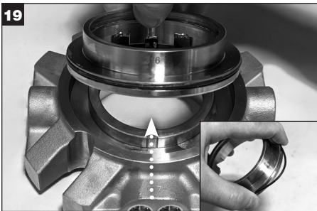
Den Adapter aus dem Dichtungsflansch entfernen und entsorgen. Den O-Ring (Z) des Adapters entfernen und entsorgen. Den Adapter zur Seite legen.
